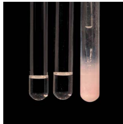
Fig. 9 – Test à la solution alcoolique de nitrate d'argent d'un dérivé halogéné tertiaire.
