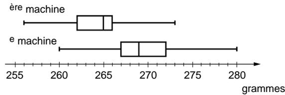
b) La dispersion est une caractéristique de chaque machine. Les deux machines semblent toutes les deux du même niveau de précision. Par contre la deuxième a tendance à produire des paquets trop lourds. La première machine semble la plus appropriée.
