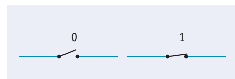
Fig. 3 : les deux états d'un interrupteur
